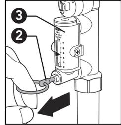
3. Den Schieber offen halten und bei Größen von 1/2" bis 1 1/4" mit einem 9 mm-Schlüssel bzw. bei Größen von 1 1/2" bis 2" mit einem 12 mm-Schlüssel auf der Ventilsteuerspindel (4) die Einstellung vornehmen. Die eingestellte Durchflussmenge wird von der Metallkugel (5) in einer transparenten Führung (6) angezeigt, neben der eine Skala steht, auf welcher der Wert in l/min abgelesen werden kann.
