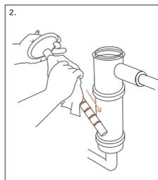
2. Entnehmen Sie den Magnetstab und reinigen Sie diesen beispielsweise mit einem Tuch.
