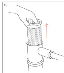
4. Nun können sie den Korb mit dem Dualfilterbeutel entfernen und ersetzen (Ersatzteilnummer 100454)
