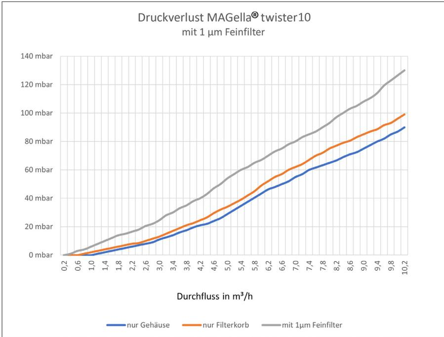
Bild 9-10: Kennlinie Dualfilter
