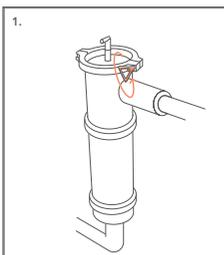
1. Schließen Sie die Ein- und Ausgangsarmatur. Öffnen Sie den KFE-Hahn, um den Druck abzulassen. Danach öffnen Sie den Entlüftungshahn oben am Filter. Drehen Sie die Flügelmutter auf uns entfernen Sie den Verschluss
