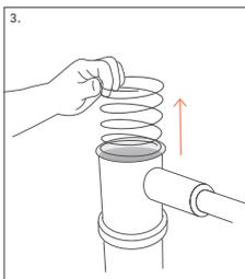
3. Entnehmen Sie anschließend die Druckfeder und reinigen Sie diese ggfls. mit Wasser
