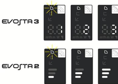
Bei diesem Einstellmodus arbeitet die Umwälzpumpe mit Kennlinien mit konstanter Geschwindigkeit.
