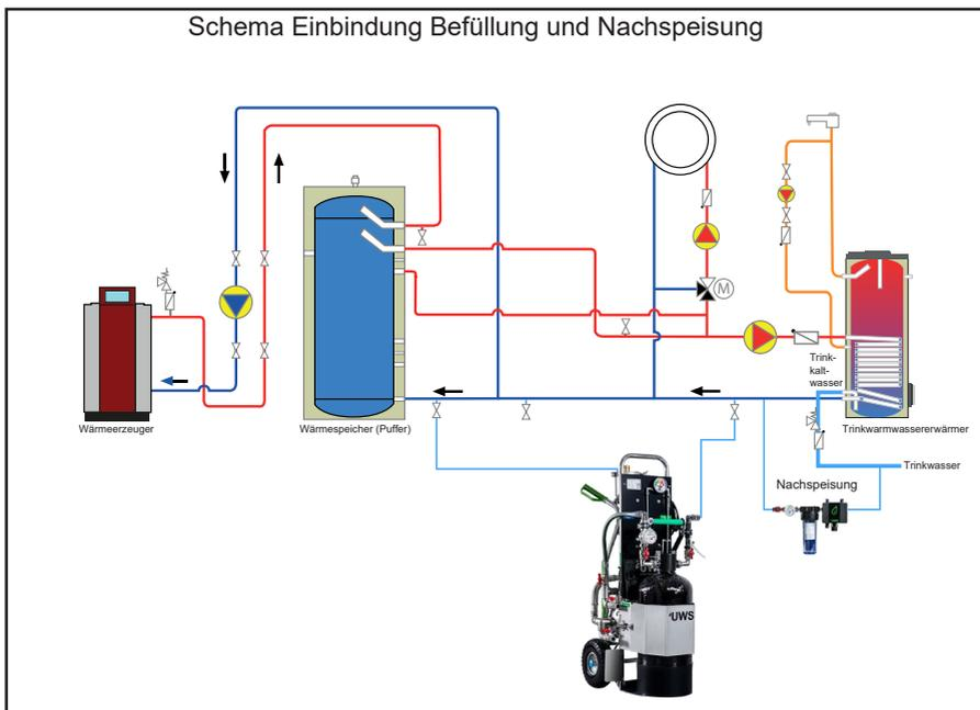
Bild 4-4: Anschlussschema Bypass-Verfahren
