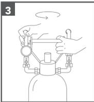
3. Drehen Sie den 3-Wege-Kopf am Griff entgegen dem Uhrzeigersinns, um den 3-Wege-Kopf zu lösen.
