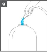
9. Befüllen Sie den Composite-Behälter bis zu einer Höhe von circa 2 cm unter dem Gewinde mit Wasser.
