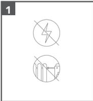
1. Stellen Sie sicher, dass das Gerät ausgeschaltet und von Stromnetz sowie Heizungs- oder Kühlanlage getrennt ist.
