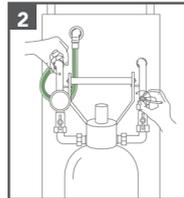
2. Entfernen Sie die Schläuche vom Gerät und öffnen Sie alle Ventile, um das Gerät zu entleeren.
