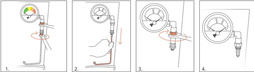
1. Lösen Sie die untere Verschraubung. Sichern Sie dabei die obere Überwurfmutter mit einem Schraubenschlüssel.
