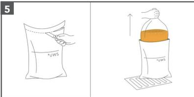
5. Entnehmen Sie das Nachfüllpack mit Mischbettharz aus der Umverpackung und stellen Sie die Umverpackung über einen Abfluss.
