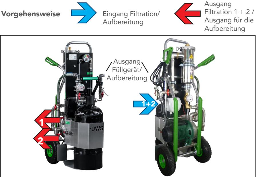
Bild 5-8: Anschlussschema Kombi
