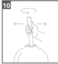
10. Verrühren Sie das Mischbettharz mit einem Rohr oder einem anderen geeigneten Werkzeug, um den 3-Wege-Kopf mit Sauglanze leichter einführen zu können.
